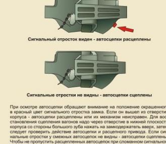
Сигнальный отросток виден - автоцепки расцеплены
