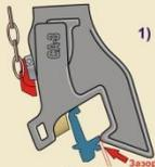
Зазор - корпус автоцепки исправен
