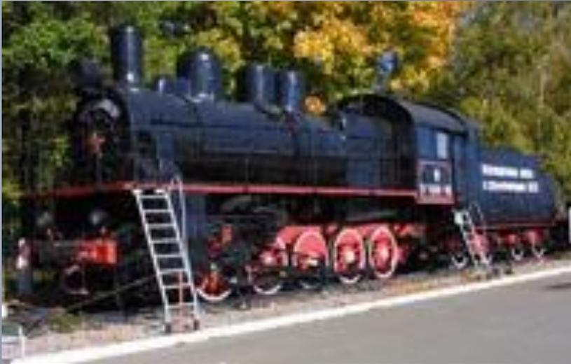
Паровоз серии Эу средней мощности, предназначен для обслуживания пассажирских и грузовых составов. Паровозы этой серии отличались мощностью и надёжностью, способностью работать на любом виде топлива. Именно этому локомотиву было суждено стать основным фронтальным паровозом. Вес 85т
