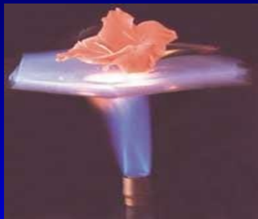
Аэрогель плохо проводит тепло
