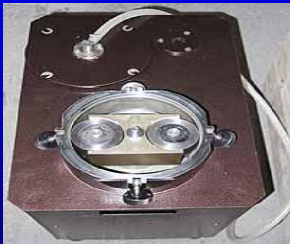
Общий вид планетарной центробежной мельницы
