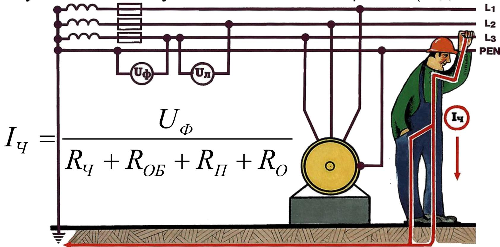
$$I_{\text{ч}} = \frac{U_{\text{ф}}}{R_{\text{ч}} + R_{\text{ОБ}} + R_{\text{П}} + R_{\text{О}}}$$
