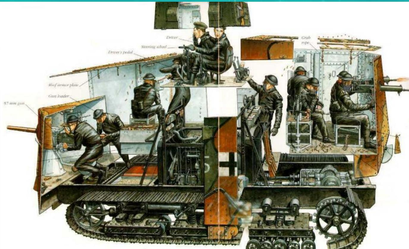
Среди главных недостатков А7V: очень плохая обзореваемость (на расстоянии до 10 метров вперёд водитель ничего не видел), большая шумность, высокая температура (до 60 °С) и загазованность внутри самого танка (во время марша экипаж сидел на крыше), а также крупные габариты, которые делали его лёгкой мишенью для артиллерии
