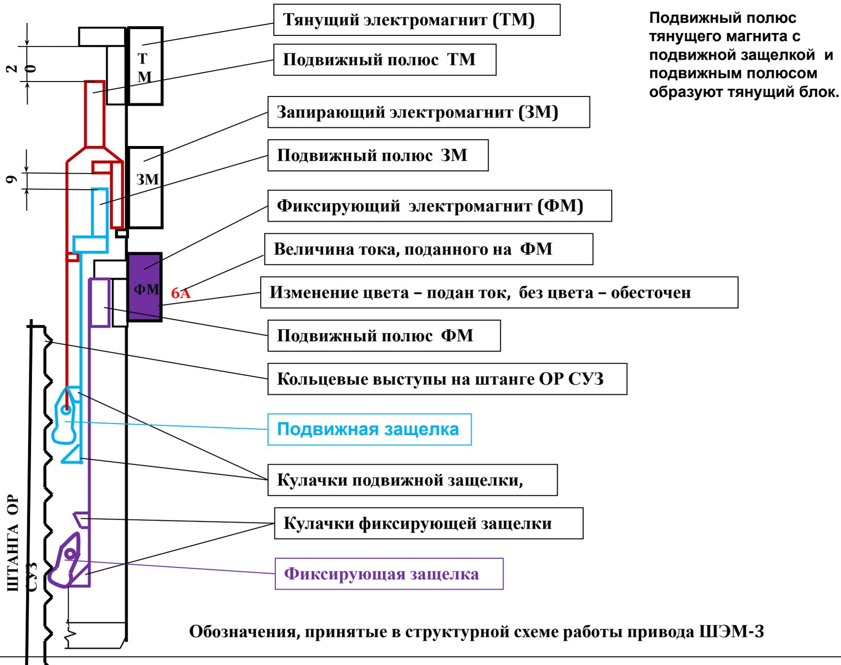
Обозначения, принятые в структурной схеме работы привода ШЭМ-3
