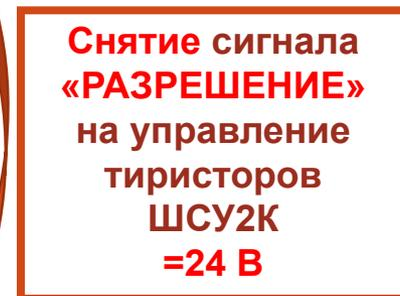
Обесточение управляющих контакторов ШПУК снимает =24 В с управляющих тиристоров основного и резервного питания. Тиристоры закрываются, силовой ток резко падает до «0». Этим обеспечивается снижение токов при отключении контакторов в ШП6К и ШП6К1
