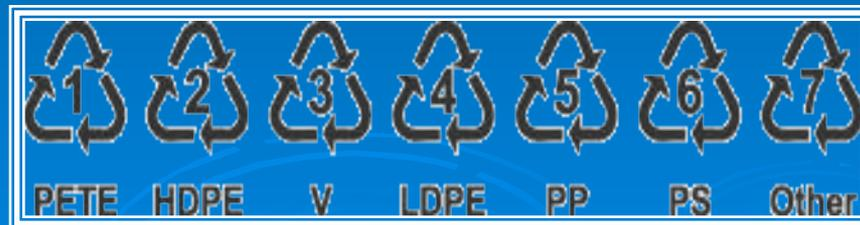
Рис. Идентификационная маркировка пластиков SPI (США).
