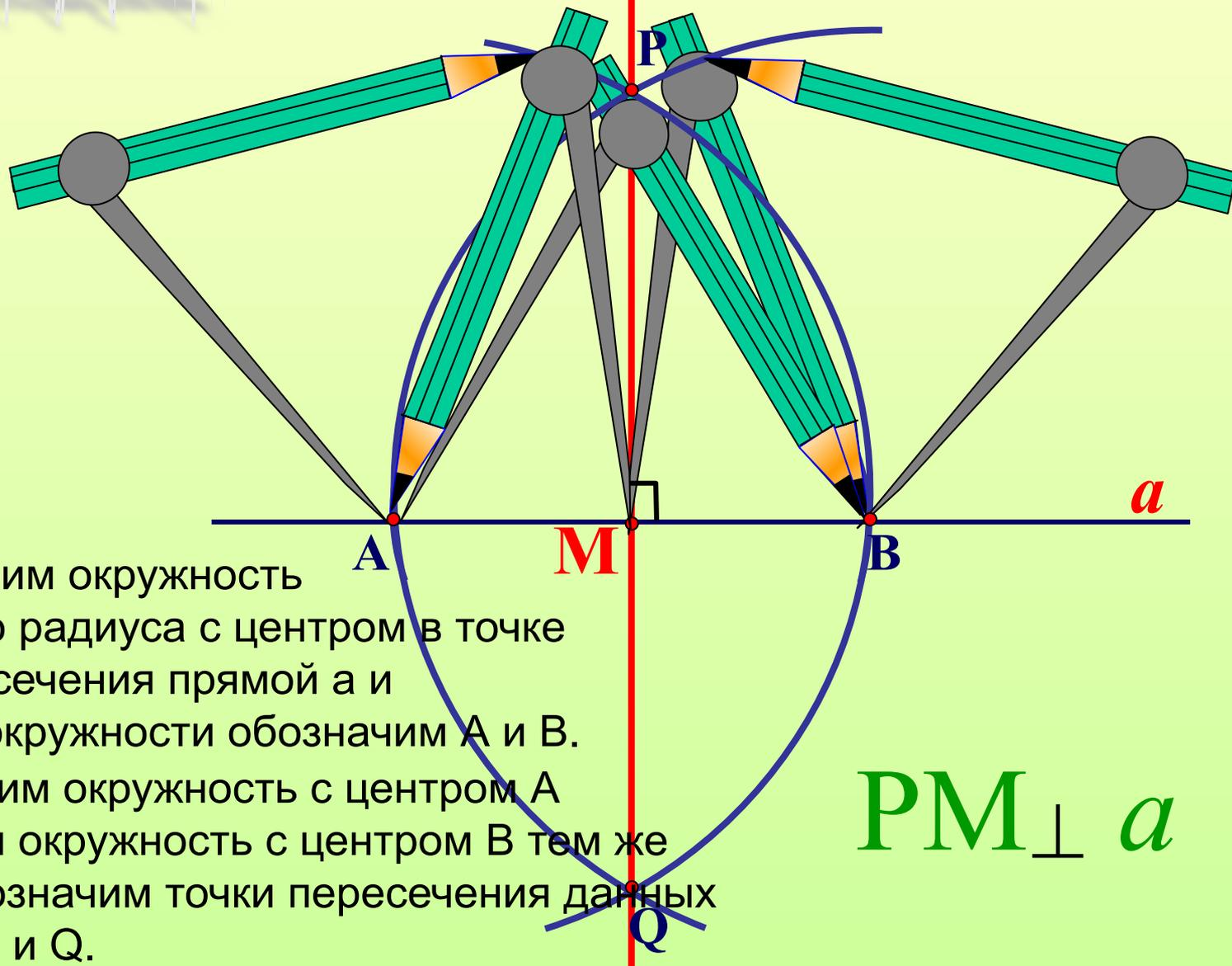
**Шаг 1.** Построим окружность произвольного радиуса с центром в точке М. Точки пересечения прямой  $a$  и построенной окружности обозначим А и В.
