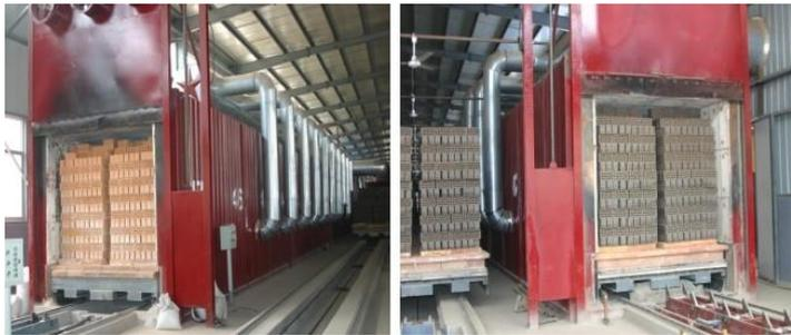
К недостаткам туннельных сушилок относятся: большое количество вагонеток и необходимость их пополнения, подверженность металлических изделий вагонеток коррозии, неравномерность сушки изделий по поперечному сечению туннеля (вверху температура теплоносителя выше, чем внизу) и необходимость круглосуточной загрузки и разгрузки вагонеток.
