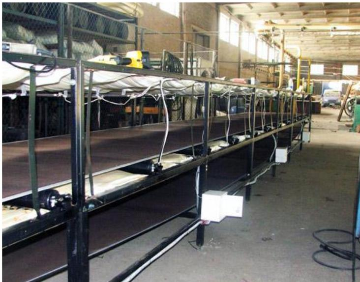
По сути, конвейерная сушилка производит свою работу посредством движущегося ленточного элемента, который проходит циклический оборот, за время которого и проходит весь процесс высушивания материала. Во время программирования данного устройства выставляется скорость прохода ленты за один цикл сушки, таким образом, для каждого материала существует определенная настройка оборудования.
