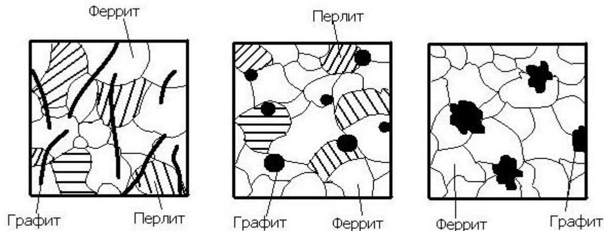
Рис.14 Схематическое изображение структур чугунов: а-серого, б-высокопрочного, в-ковкого.
