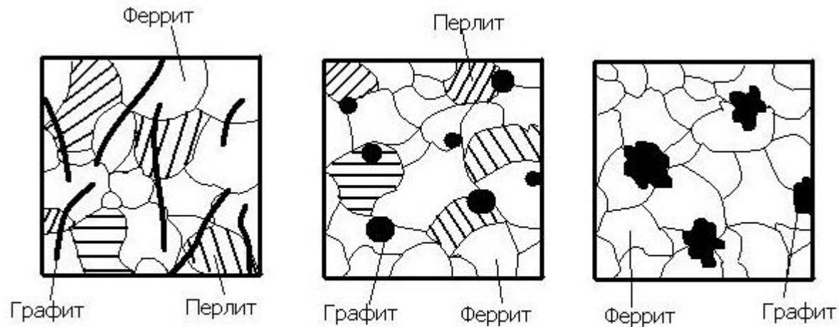
Рис.14 Схематическое изображение структур чугунов:
