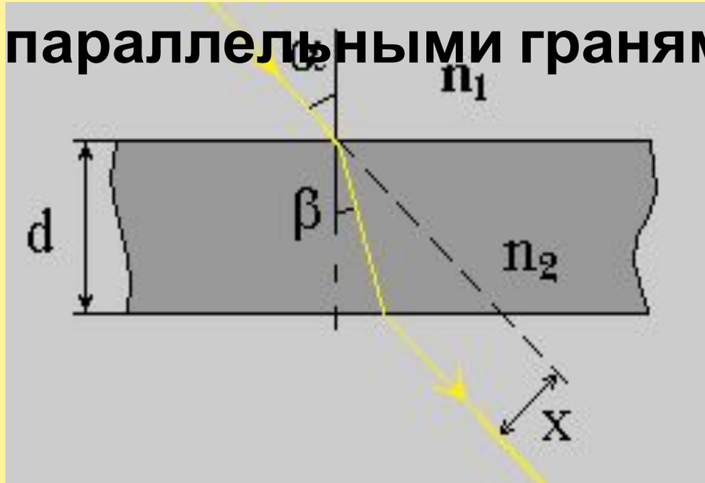
При прохождении света через плоскопараллельную пластину свет дважды на своем пути претерпевает преломление, в результате чего луч падающий на пластину и луч выходящий из нее оказываются параллельными, но смещенными друг относительно друга. Поэтому стеклянная пластинка не искажает, а только смещает предметы относительно их действительного положения.
