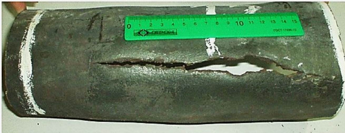
д) пластически деформированная труба с продольной трещиной
