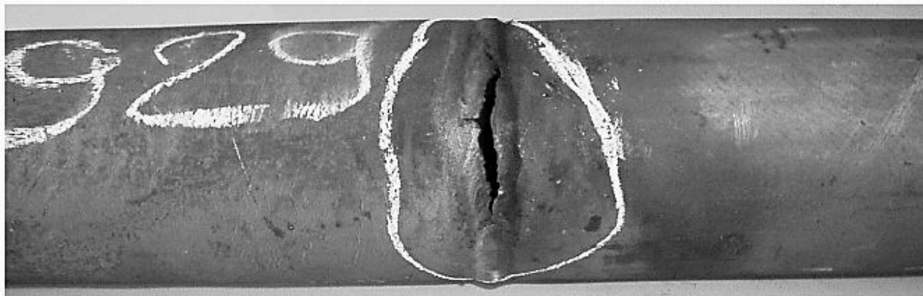
а) фрагмент труб в зоне сварного шва с трещиной.
