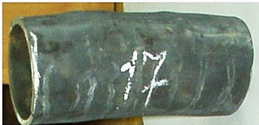
б) необратимая пластическая деформация формы трубы
