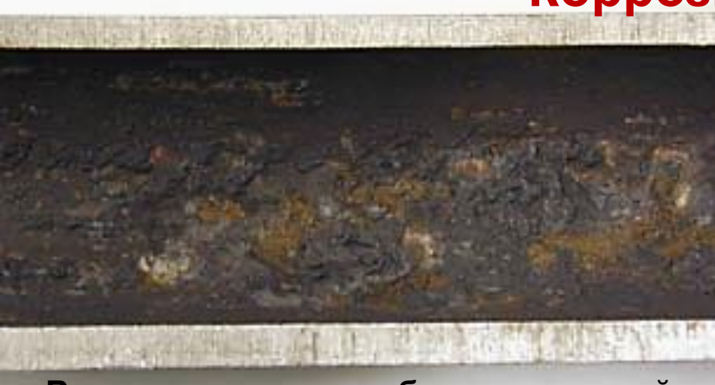
Вид поверхности трубы со сплошной коррозией
