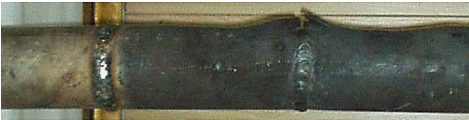
г) пластически деформированная труба с трещиной в сварном шве
