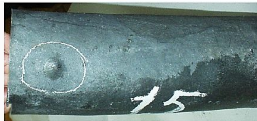
в) труба с отдулиной
