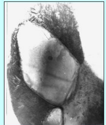
Структура глобулярно-пластинчатого типа сплава ВТ6 x 24000
