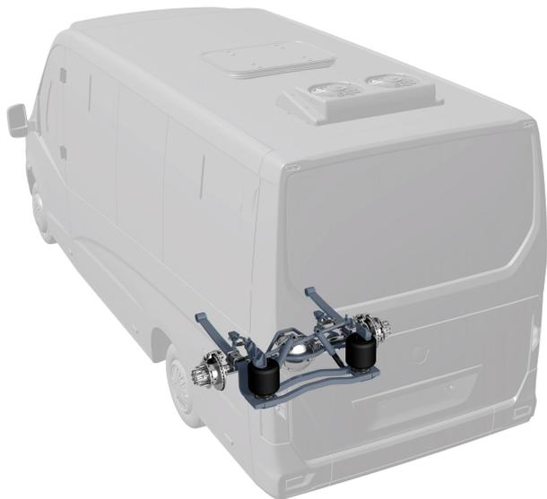
Задний мост увеличенной грузоподъемности (тип Spicer ) с дисковыми тормозами на пневмоподвеске.
