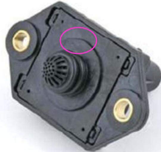
安装要求：该传感器要求安装在空气滤清器和增压器之间的空气管路上，环境传感器安装座由玉柴提供，汽车厂负责将环境传感器安装座焊接在进气管路上，焊接时必须保证焊接部位密封可靠。为保证环境传感器测量值正确，安装时必须保证传感器底面4个湿度测量小孔不被挡住，并且该传感器温度、压力探头必须置于气流中以测量正确值。
