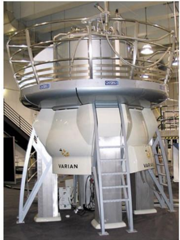
Магнит спектрометра Varian 900 МГц
