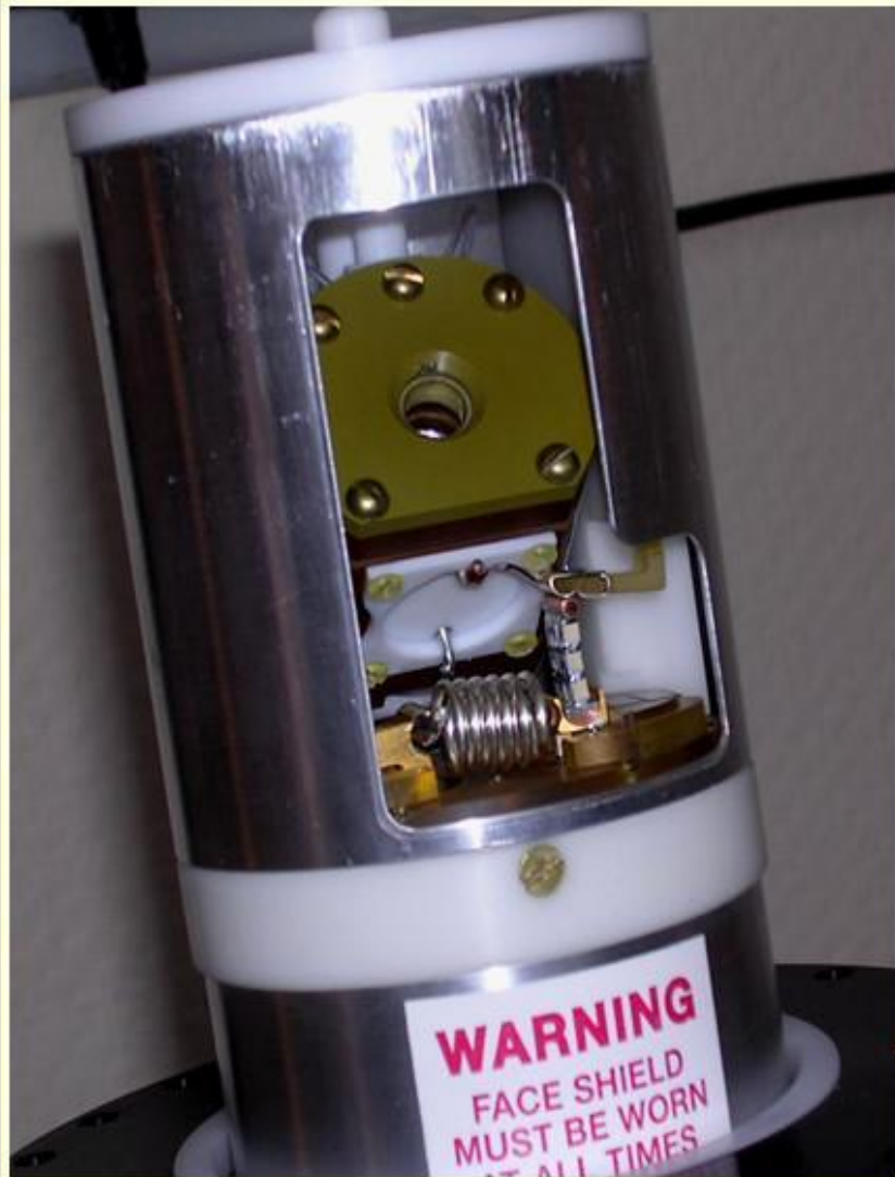
Твердотельный ЯМР датчик
