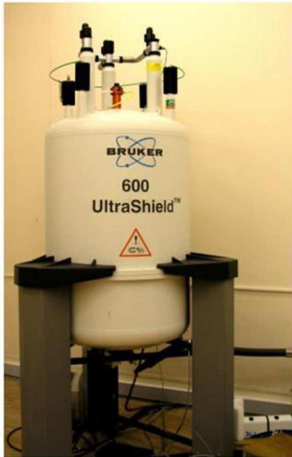
Магнит спектрометра Bruker AVANCE 600
