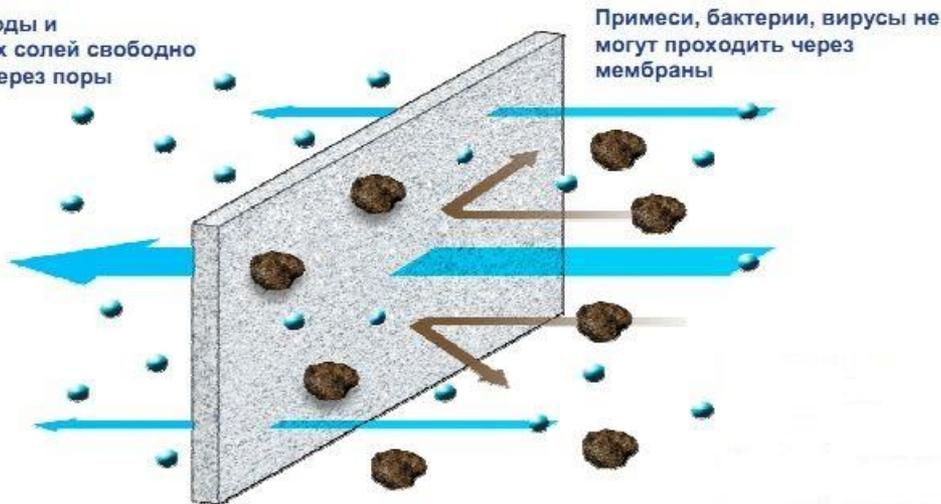
Мембранная «стена», имеющая селективную пропускную способность
