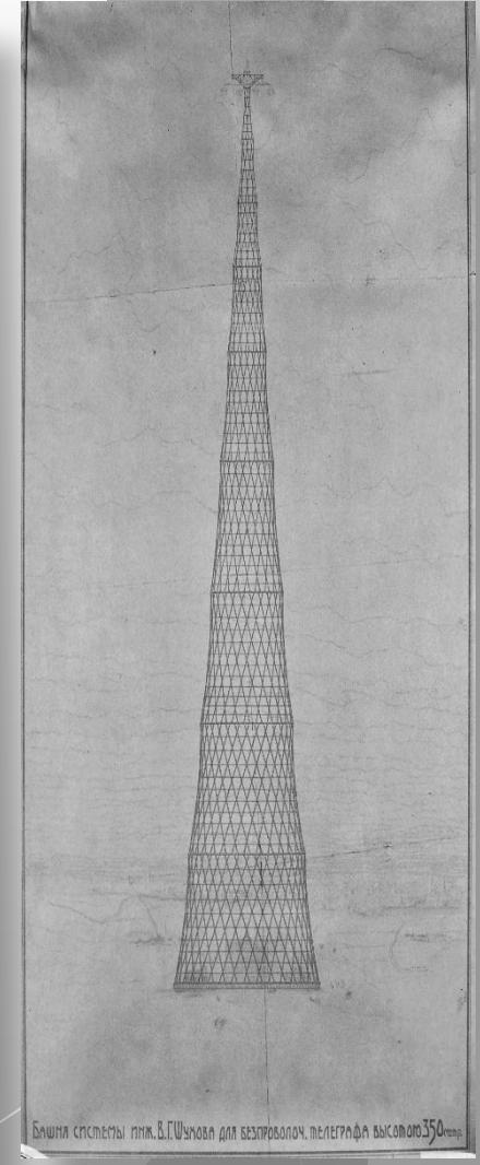
Башня системы инж. В.Г.Шухова для беспроводоч. телеграфа высотой 350 м.
