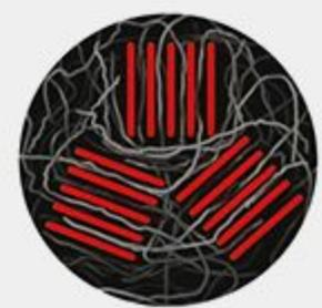
Интеркалированный — отдельные кристаллиты глины в смеси. Взаимное расположение силикатных пластин сохраняется. Размеры 15—20x70—1000 нм
