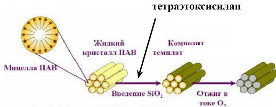
Рис. П.9. Схема синтеза мезопористого оксида кремния
