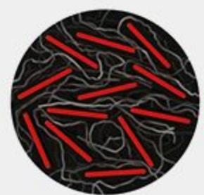
Эксфолированный — отдельные силикатные пластины хаотично распределены в полимере. Размеры 1—2x70—1000 нм
