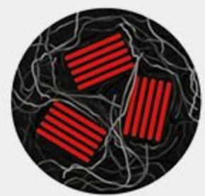
Фазоваразделенный микрокомпозит — отдельные кристаллиты глины в смеси. Полимер не проникает между силикатными пластинами. Размеры 10—20x70—1000 нм
