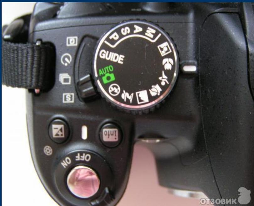
**Диск выбора режимов** – специальная кнопка предназначенная для выбора режима съемки, ручного (M) полуавтоматических (P, A или Av, S или Tv) и полностью авто режимов
