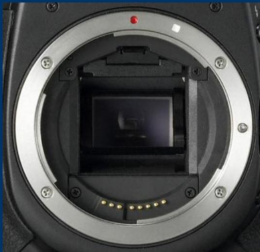
**Байонет** – система крепления объектива к камере. Основные типы – Canon EF, Nikon F, Sony E. Замена объектива - нажать на кнопку рядом с байонетом, повернуть объектив, новый объектив совместить по метке на камере, повернуть до щелчка.
