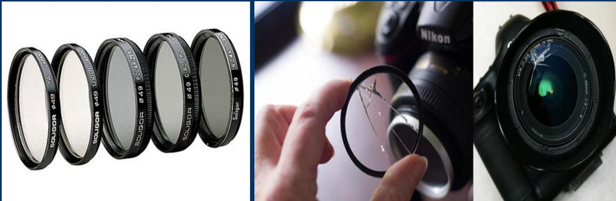
Светофильтры это специальные стеклянные пластины в металлической оправе, прикрепляются к резьбе объектива. Разные фильтры позволяют получать разные эффекты при съемке, усиливать цвета, добавлять оттенки, затемнять определенные области на фото итп. В основном применяют прозрачные защитные фильтры, их задача защитить переднюю линзу объектива от повреждения при ударе.
