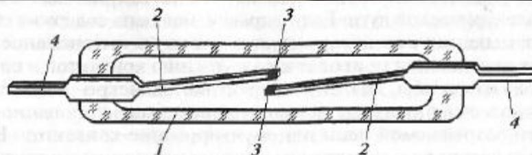
Рис. 10.5. Устройство геркона:
