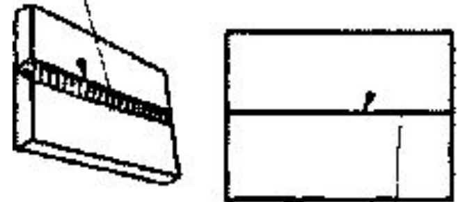
Изображение видимого сварного шва
