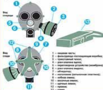
Подбор лицевой части противогазов ГП-7, ГП-7В, ГП-7ВМ
