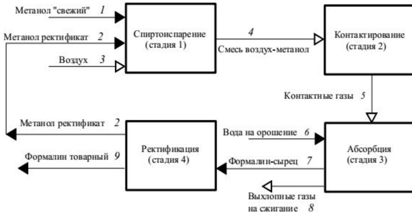
Рис. 1. Схема материальных потоков производства 37%-го формалина
