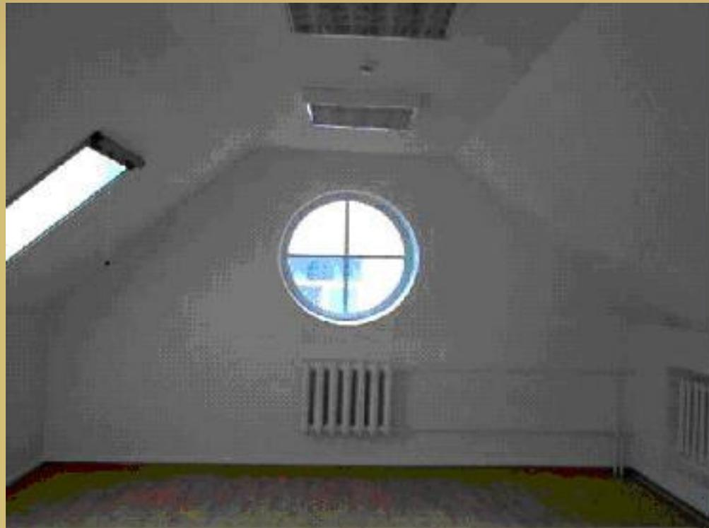
Справочно: мансардный этаж – помещение в чердачном пространстве высокой крыше строения, оборудованное стенами и потолком внутри чердака, площадь которого не менее половины площади пола, а высота стен до низа наклонной части потолка при соблюдении условия пропорции площадей не менее 1.60 м.
