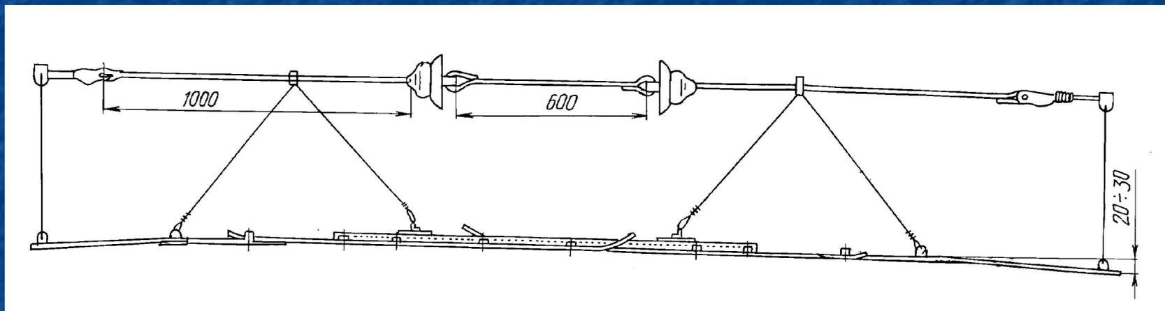
**При полукомпенсированной подвеске на расстоянии более 200 м от средней или жесткой анкеровки секционные изоляторы подвешиваются на скользящих струнах, обеспечивающем его продольное перемещение.**
