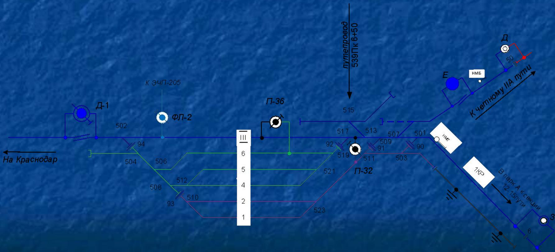
**В отдельные продольные секции выделяют контактную сеть перегонов, подстанций, разъездов и обгонных пунктов. На крупных станциях, имеющих несколько электрифицированных парков или групп путей, контактная сеть каждого парка или групп путей образует самостоятельные продольные секции. На станциях, имеющих значительное путевое развитие, применяют дополнительное поперечное секционирование. Число поперечных секций определяется числом и назначением отдельных путей.**
