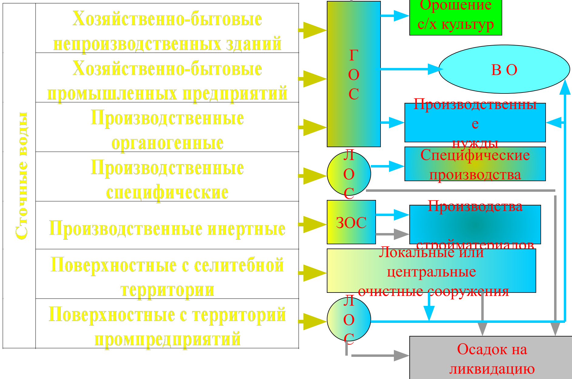
Рис. 14. Граф для полной раздельной системы водоотведения города
