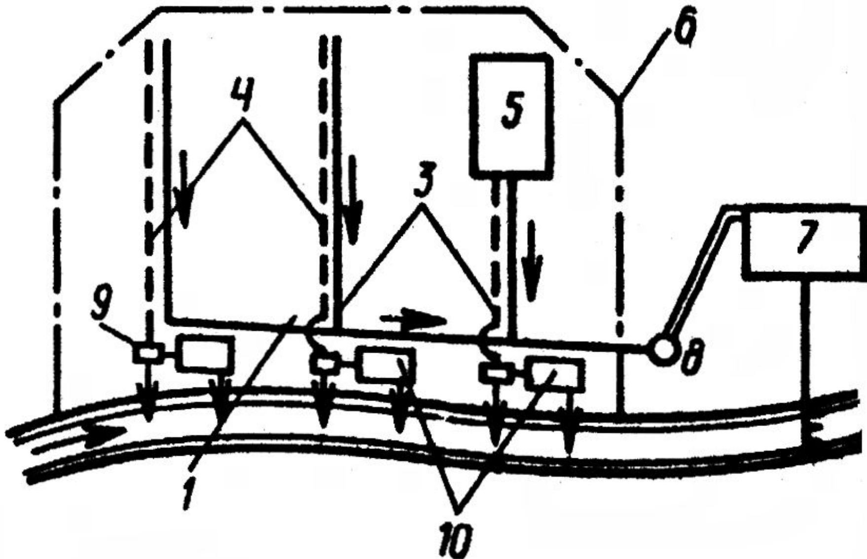
Рис. 5. Схема полной раздельной системы водоотведения города с локальной очисткой поверхностного стока
