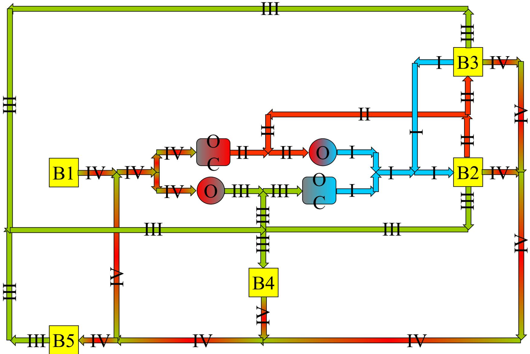
Принципиальная схема водоотведения промышленного предприятия при частичной утилизации производственных сточных вод
