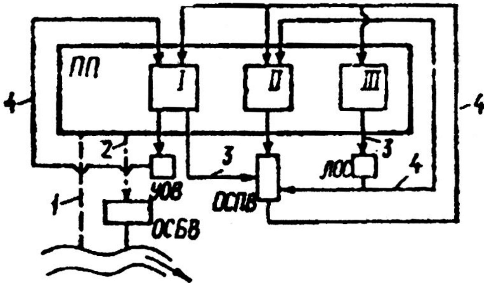
Рис. 10а. Схема отдельной системы водоотведения промышленного предприятия с полным оборотом производственных сточных вод (вариант 1)
