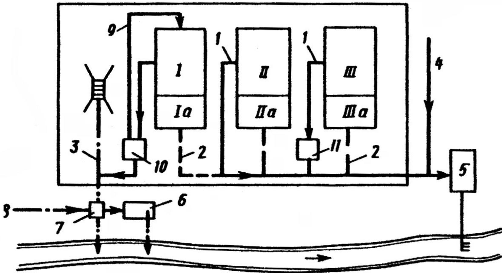
Рис. 9б. Схема раздельной системы водоотведения промышленного предприятия с частичным оборотом производственных сточных вод (вариант 2)
