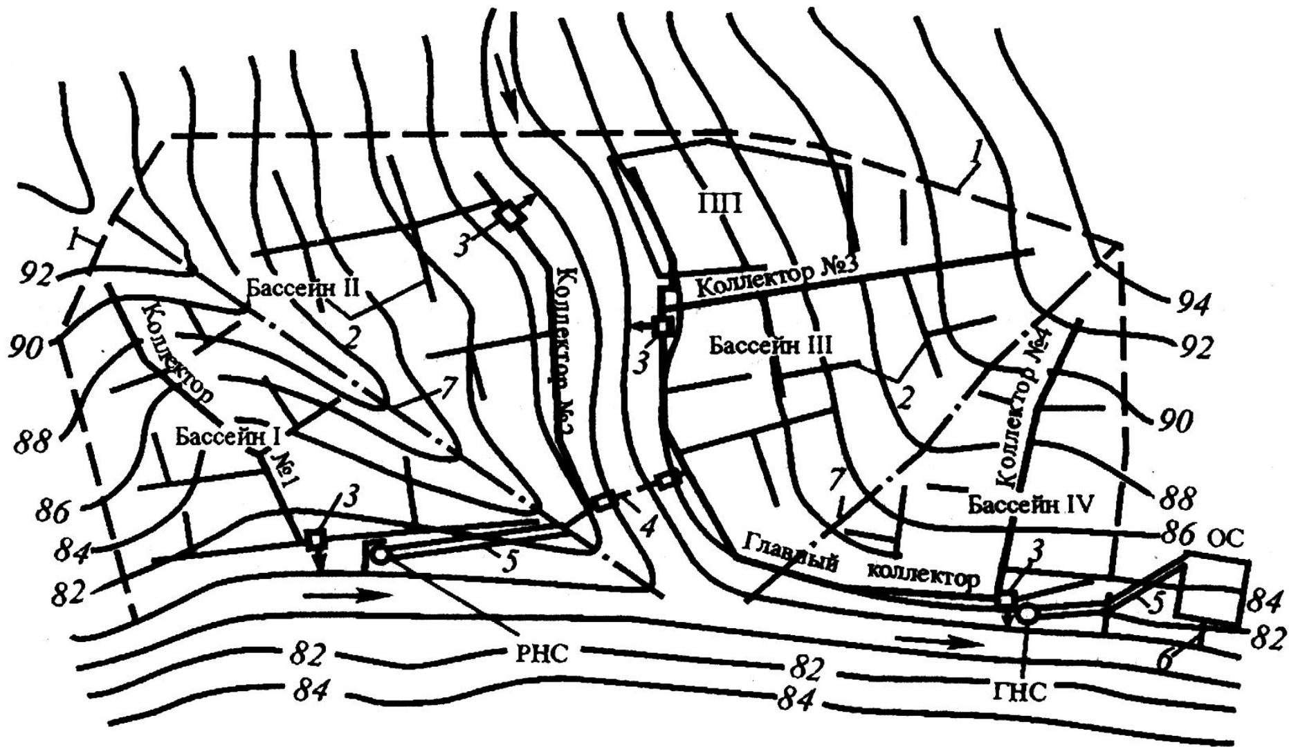
Рис1а. Общая схема системы водоотведения города
