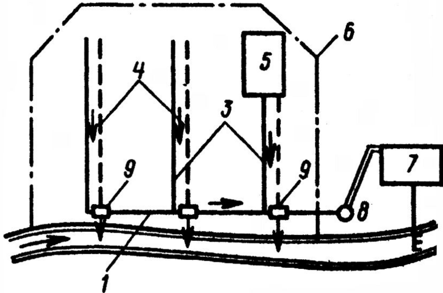
Рис. 3. Схема полураздельной системы водоотведения города
