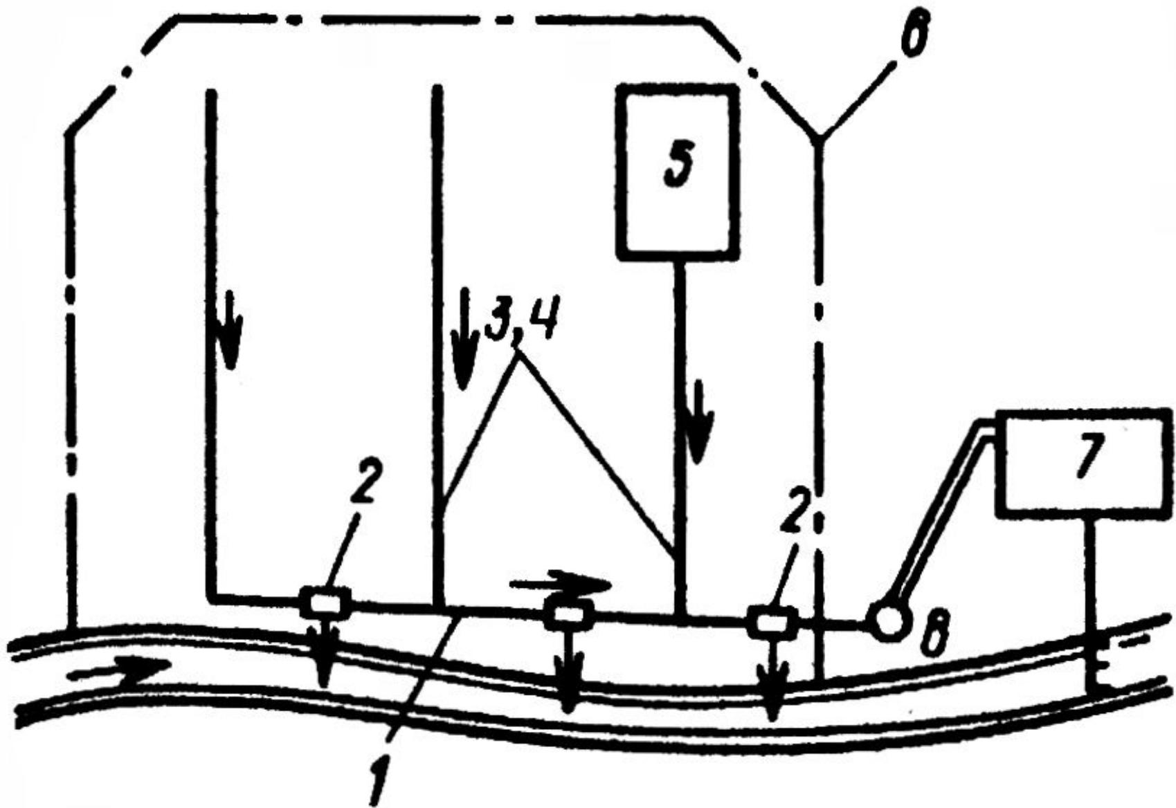
Рис. 2. Схема общесплавной системы водоотведения города
