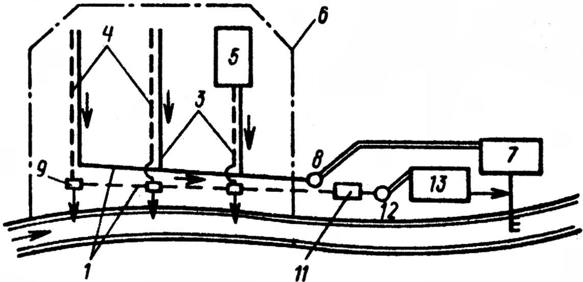
Рис. 6. Схема полной раздельной системы водоотведения города с централизованной очисткой поверхностного стока
