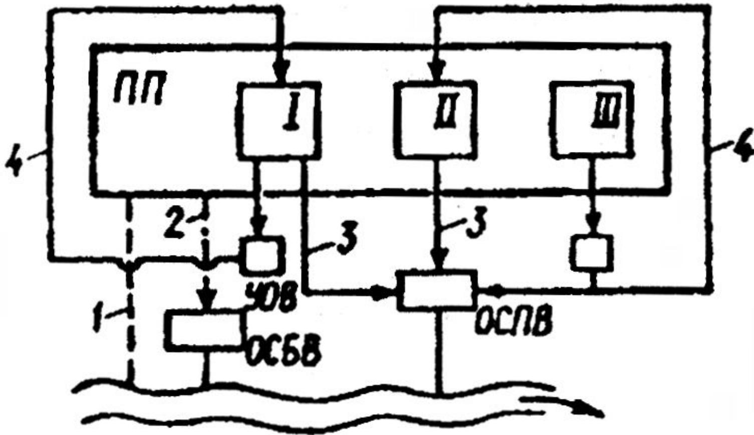
Рис. 9а. Схема отдельной системы водоотведения промышленного предприятия с частичным оборотом производственных сточных вод (вариант 1)
