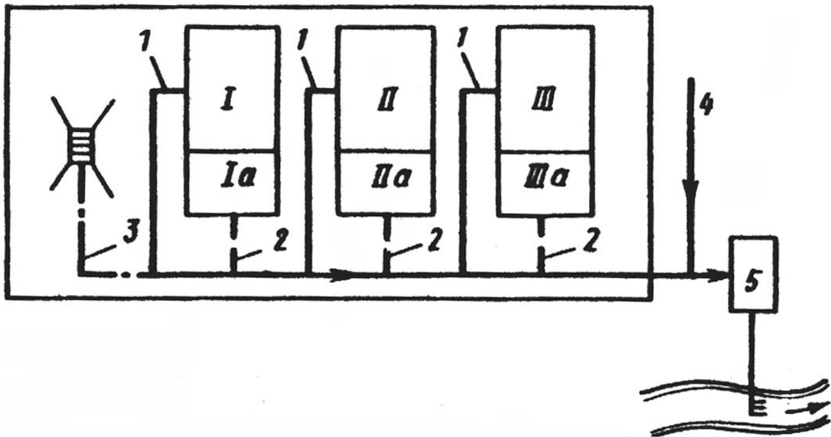
Рис. 76. Схема общесплавной системы водоотведения промышленного предприятия (вариант2)
