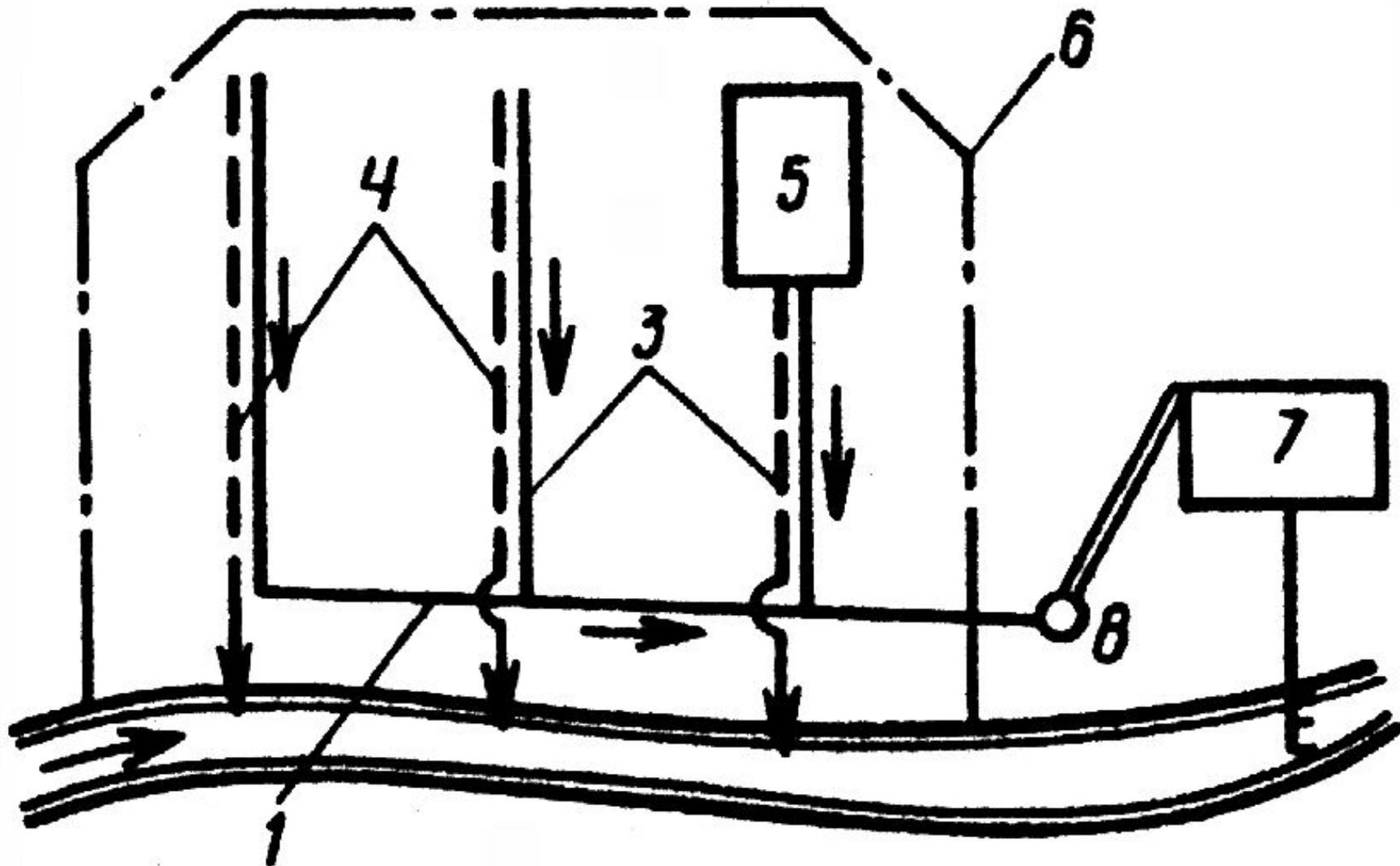
Рис. 4. Схема полной раздельной системы водоотведения города без очистки поверхностного стока.
