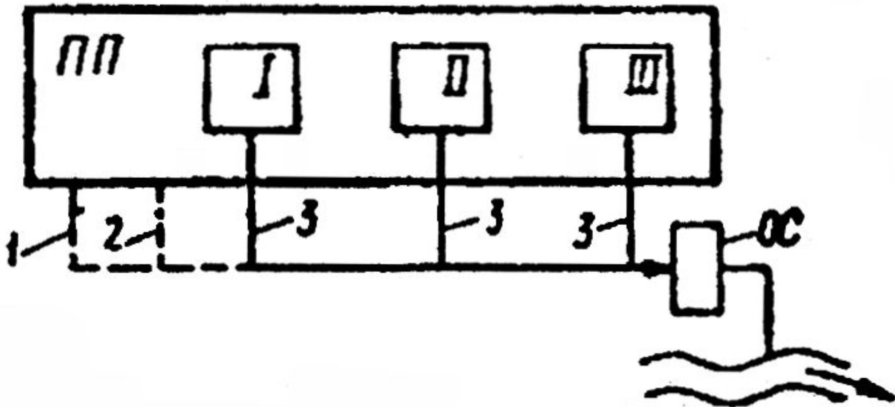
Рис. 7а. Схема общесплавной системы водоотведения промышленного предприятия (вариант 1)
