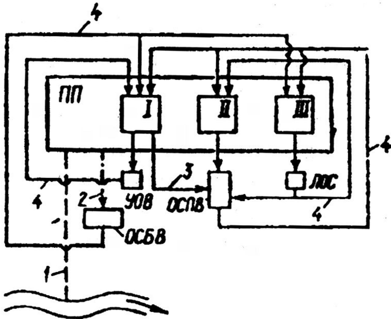
Рис. 11. Схема отдельной системы водоотведения промышленного предприятия с полным оборотом производственных и хозяйственно-бытовых сточных вод
