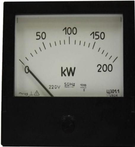
□ 4. **Ваттметры и варметры** — измеряют мощность электрического тока. Принцип работы основан на взаимодействии двух катушек. Одна из них — неподвижная, имеет толстую обмотку с небольшим числом витков и малое сопротивление.
