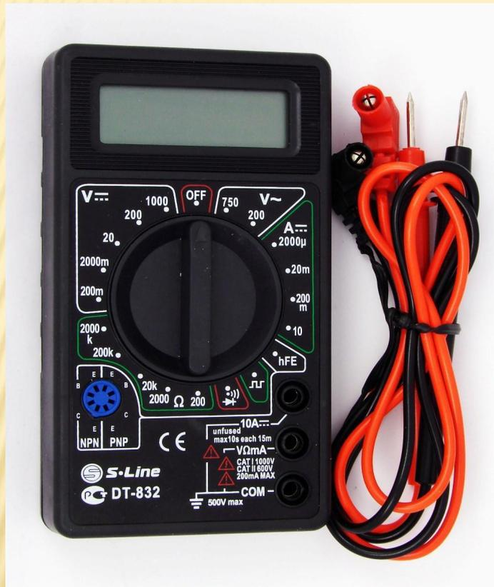
6. **Мультиметры** (иначе тестеры, авометры) — комбинированные приборы. В минимальном наборе включает функции вольтметра, амперметра и омметра. Иногда выполняется мультиметр в виде токоизмерительных клещей. Мультиметр может быть как лёгким переносным устройством, используемым для базовых измерений и поиска неисправностей, так и сложным прибором со множеством возможностей.
