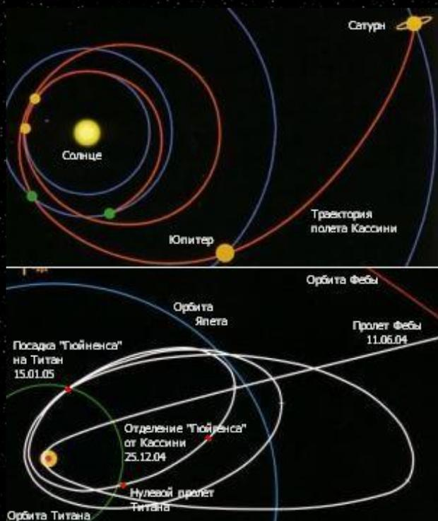
Для разгона аппарат провел несколько гравитационных маневров. "Кассини" два раза пролетел рядом с Венерой - в 1998 и 1999, затем, в августе 1999 со скоростью 69 тыс. км/час прошёл около Земли, зимой 2000 пролетел мимо Юпитера, передав на Землю его фотографии.
