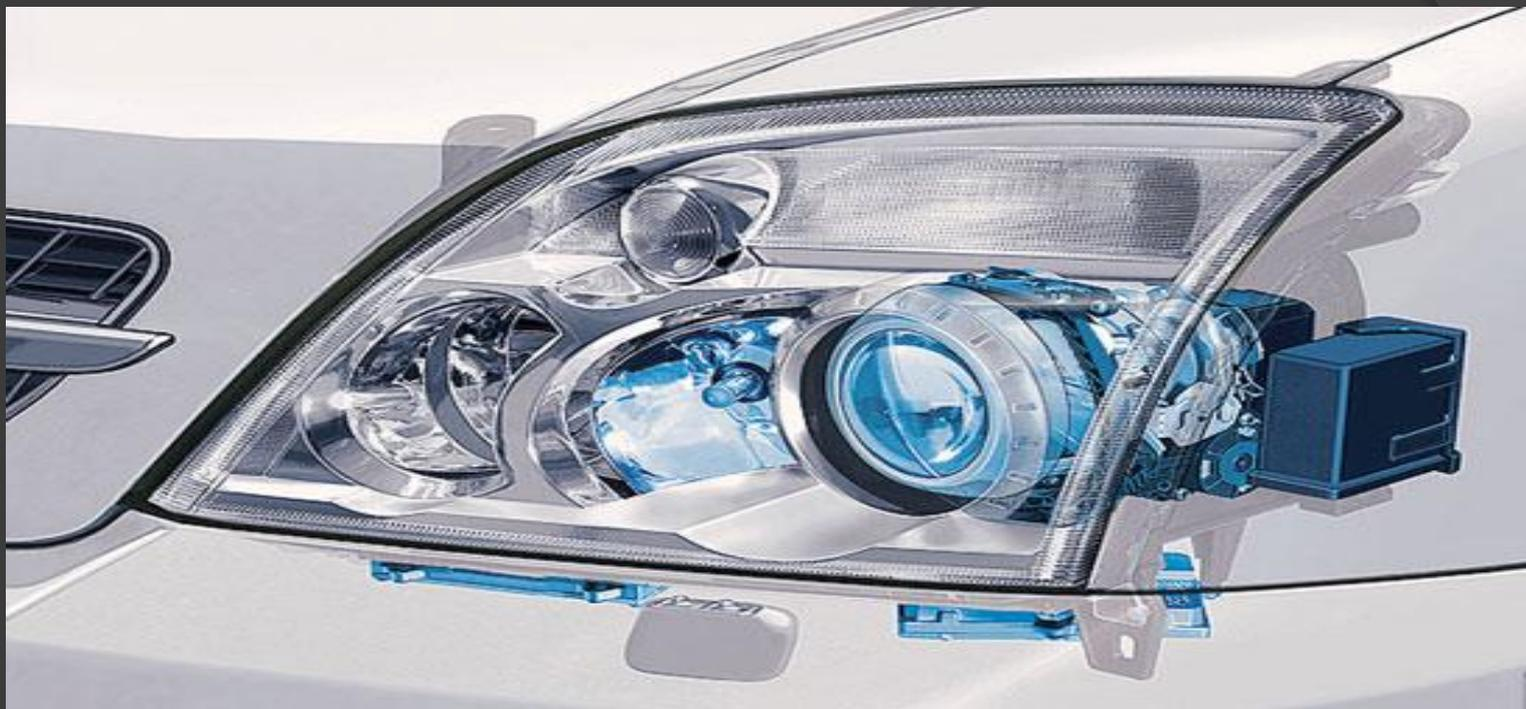
Колба всех ламп выполнена из особого кварцевого стекла, которое намного лучше противостоит интенсивному нагреву от нити накаливания. Поэтому нет необходимости делать их объемными, отдаляя стеклянную поверхность от источника тепла.
