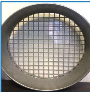
Сито с размером ячеек 16 мм
