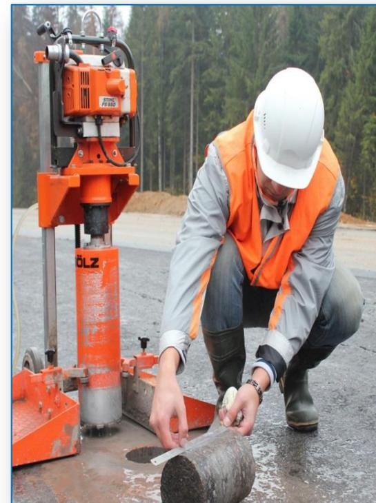
Отклонение по толщине слоя асфальтобетона относительно проектных значений в большую сторону не нормируется
