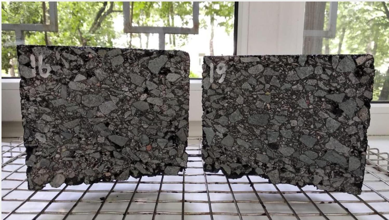
**Вывод:** Образцы SP-19 и SP-16 имеют схожую внутреннюю структуру
