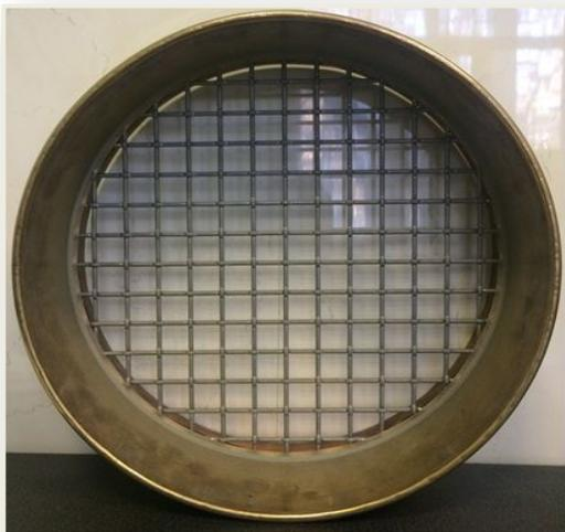
Сито с размером ячеек 19 мм
