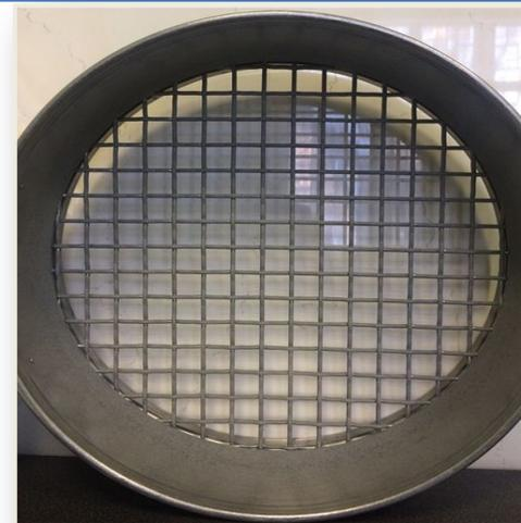
Сито с размером ячеек 16 мм
