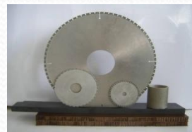
Алмазно – абразивные круги (барабаны) для высокопродуктивной механообработки полимерных композиционных материалов
