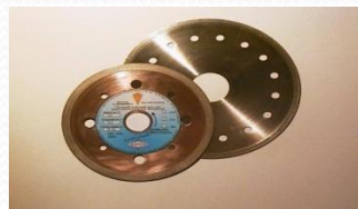
Алмазно – абразивные круги (барабаны) для высокопродуктивной механообработки полимерных композиционных материалов
