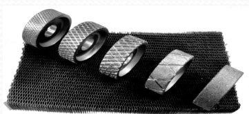
Алмазно – абразивные круги (барабаны) для высокопродуктивной механообработки полимерных композиционных материалов
