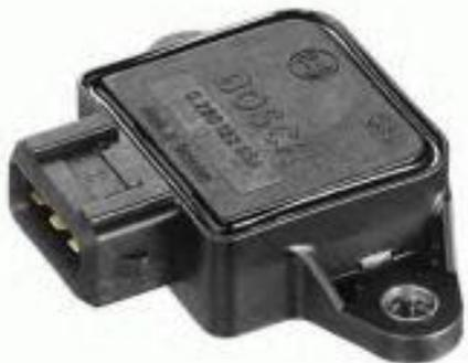
Для определения степени и скорости открытия дроссельной заслонки применяется датчик положения дроссельной заслонки. Конструктивно датчик представляет собой потенциометр, обеспечивающий изменение выходного напряжения в зависимости от положения дроссельной заслонки. Поэтому, другое наименование датчика – потенциометр дроссельной заслонки.
