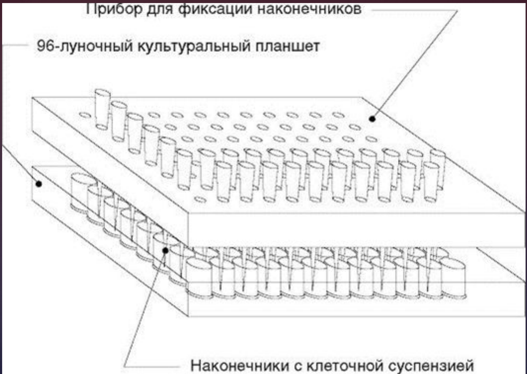
Схема МИГРОСКРИН - устройства для количественной оценки миграции клеточных культур
