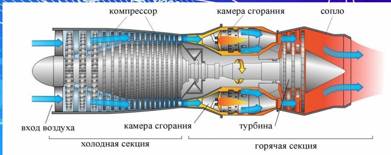
Устройство турбореактивного двигателя
