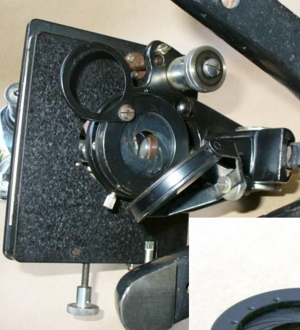
предметний столік (знизу), конденсор, ніжки станіни
