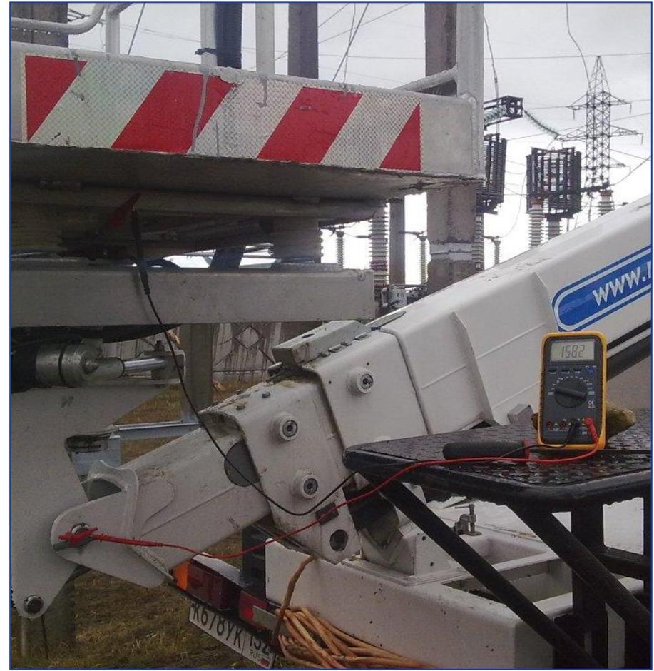
**Наведенное напряжение на изолированной корзине автоподъемника, расположенного в РУ-110 кВ, составило более 158 В.**
