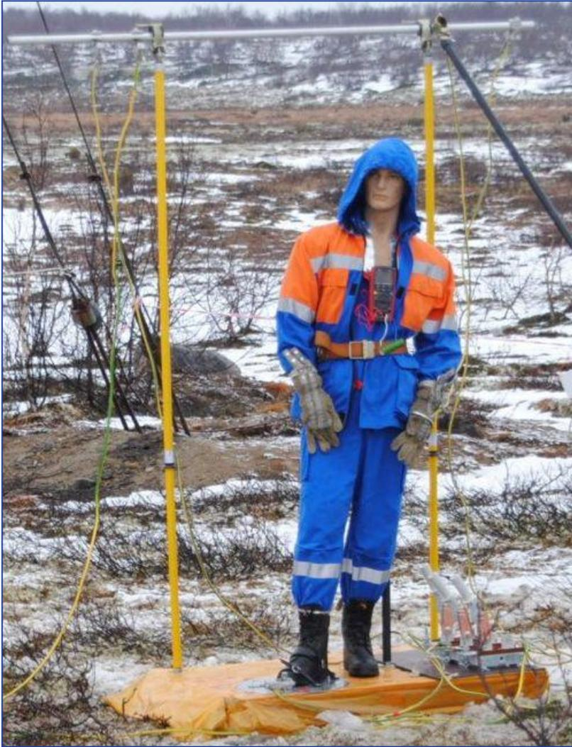
Для проверки защитных свойств комплекта было проведено испытание на действующей ВЛ.
