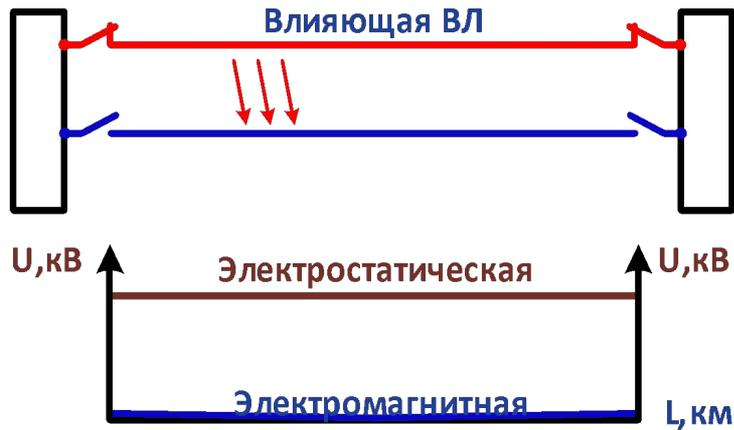
При отсутствии заземлений на отключенной ВЛ появляется статическая составляющая наведенного напряжения, достигающая нескольких киловольт. Значение наведенного напряжения электростатической составляющей равномерно по всей трассе.
