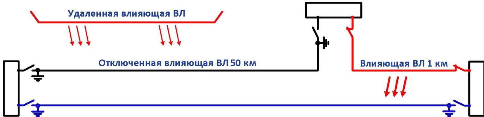
Самым эффективным и безопасным способом снижения наведенного напряжения является отключение или вывод в ремонт влияющих ВЛ.
