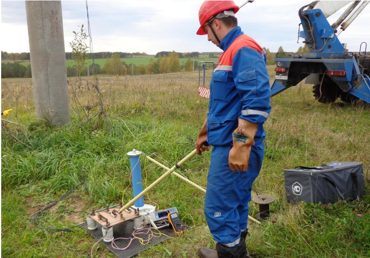
**Измерение наведенного напряжения выполняется цифровыми приборами с автоматическим переключением предела измерения.**
