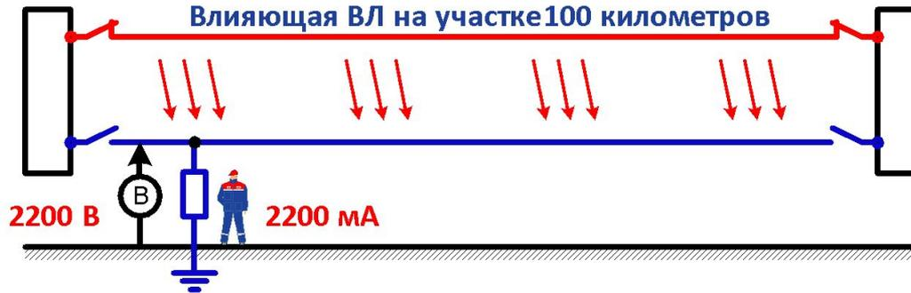
Наведенное напряжение на участке 100 км составило 8,5 кВ. При емкости ВЛ  $1,1 \times 10^{-9}$  Ф/км, в случае прикосновения к ней человека с сопротивлением 1000 Ом напряжение и ток равны: ↓
