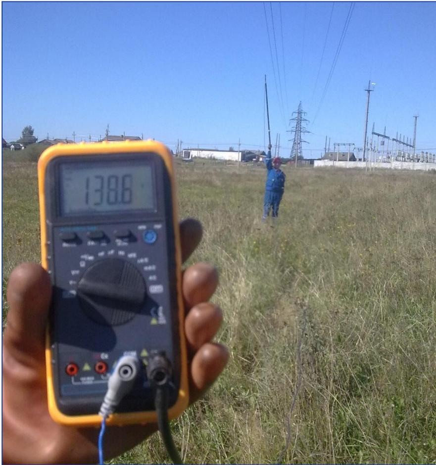
**Наведенное напряжение на изолированном проводе длиной 20 метров, протянутом вдоль ВЛ-110 кВ, составило более 138 В.**
