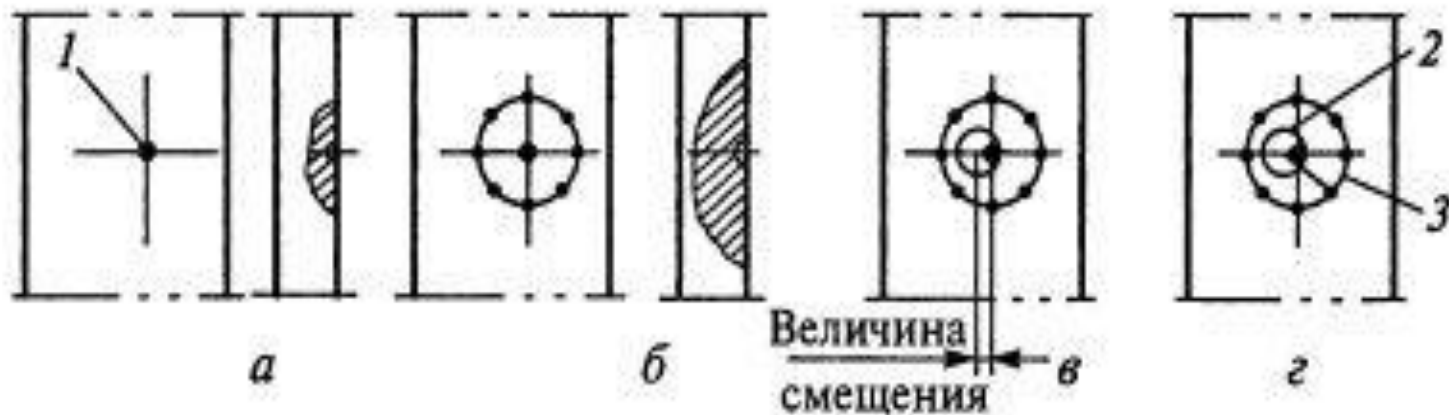
Рис. 6.21. Сверление отверстий по разметке:
