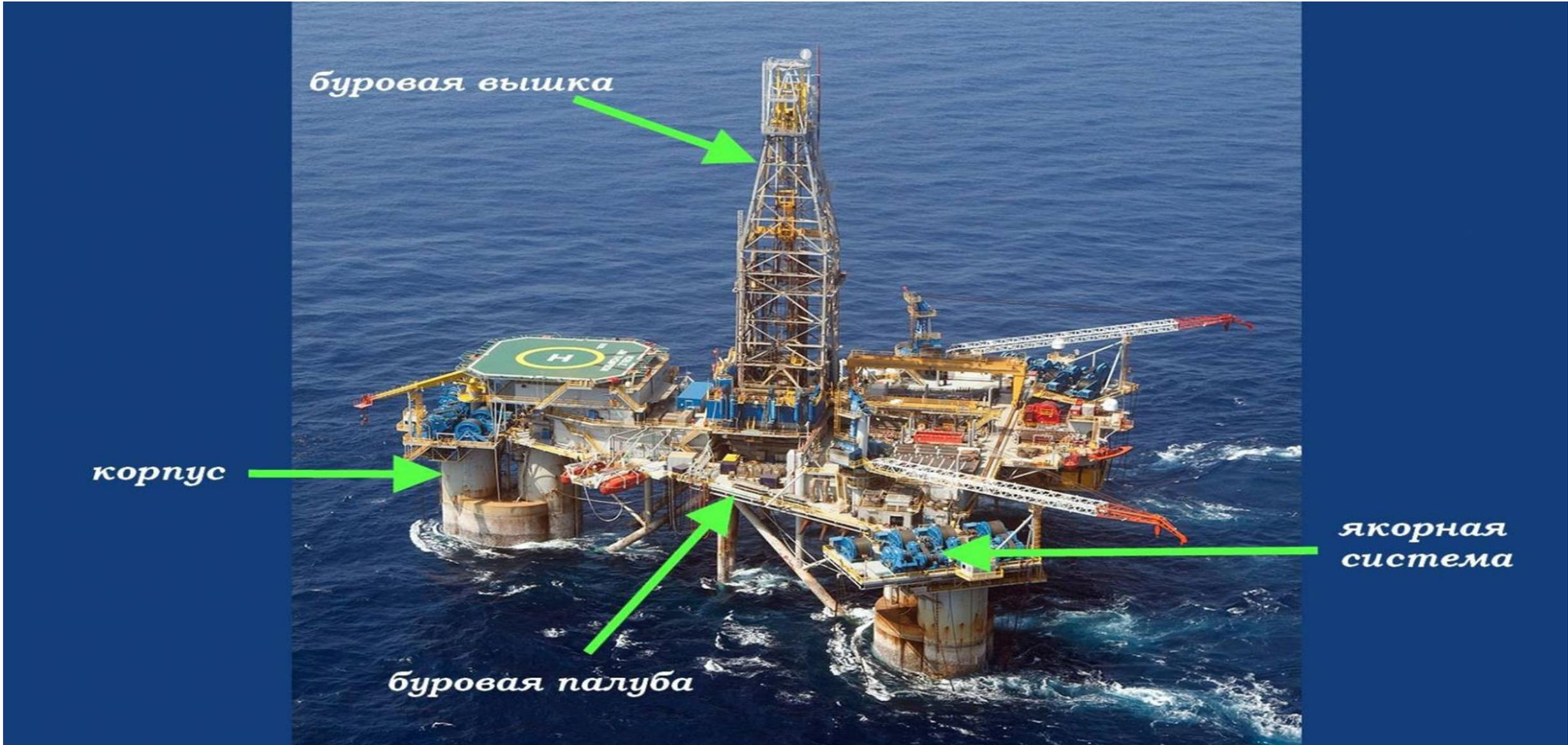
**Корпус** представляет собой понтон, своего рода стальной спасательный круг с треугольным или четырехугольным основанием, которые поддерживает шесть огромных колон. Каждая секция наполнена воздухом, что позволяет удерживать наплаву все морское сооружение.
