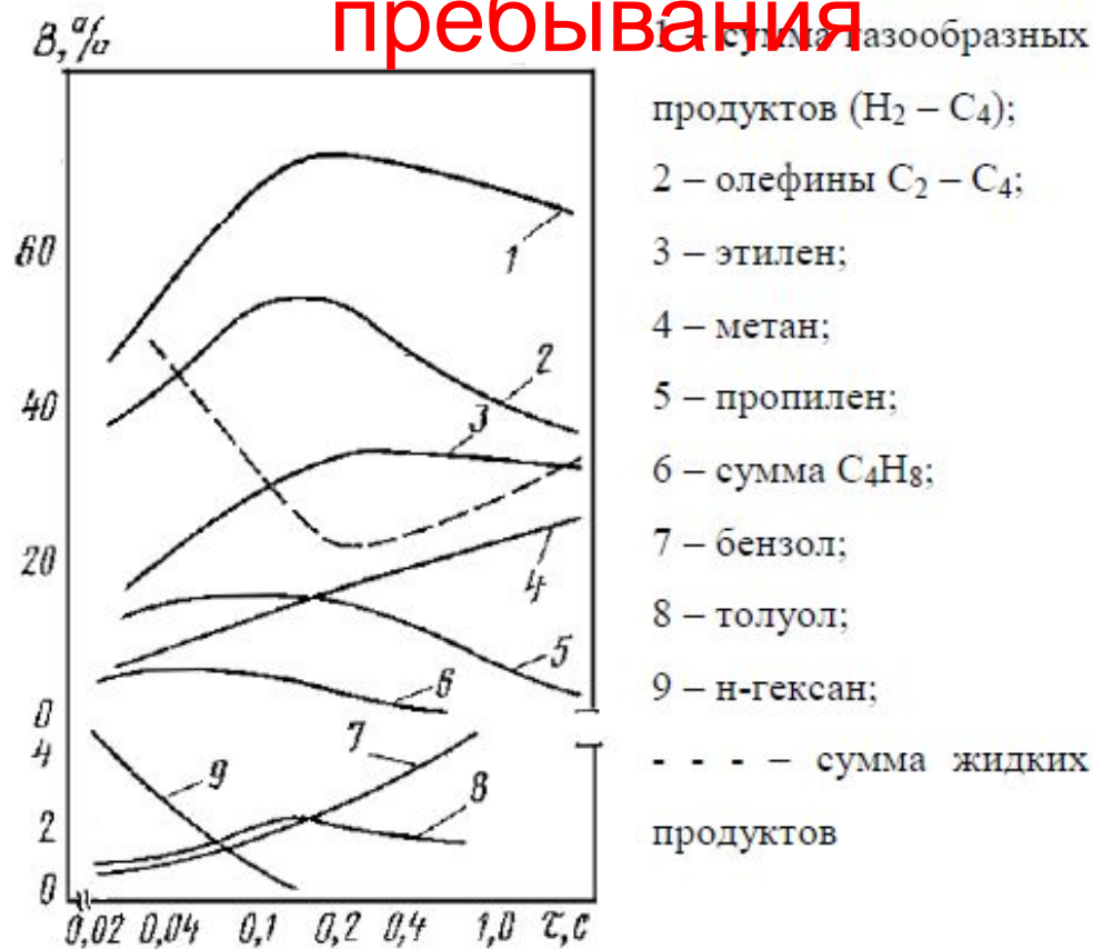
Рисунок 1.3 – Зависимость выходов V продуктов пиролиза прямогонного бензина от времени пребывания \tau при температуре 800 °C
