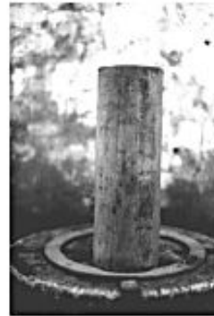
стальная труба \varnothing 150 \times 12 мм с зацементированными отверстиями \varnothing 6 - 12 мм
