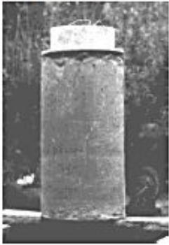
асбоцементная труба \varnothing 200 \times 18 мм с дополнительной цементной оболочкой толщиной 25 мм
