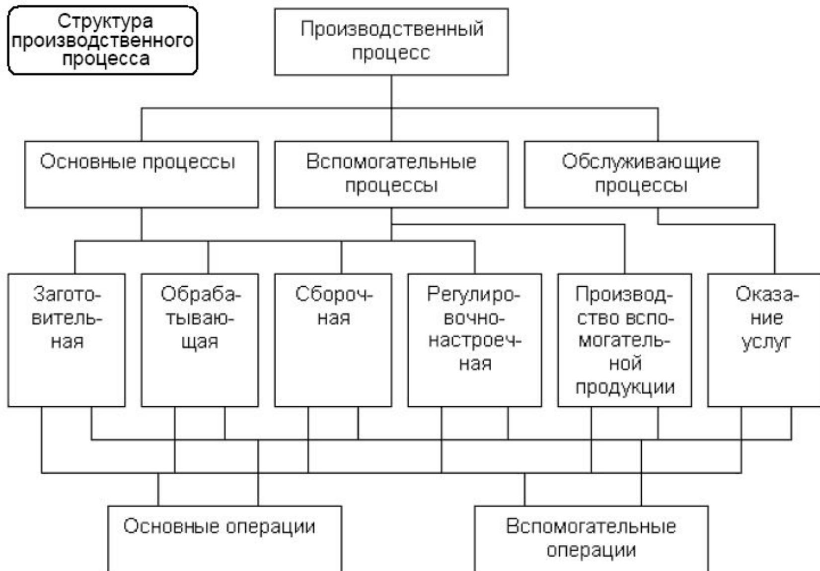
**Производственный процесс** – совокупность действий рабочих и орудий производства, в результате которых исходные материалы, полуфабрикаты превращаются в готовую продукцию (платы, ячейки, блоки).
