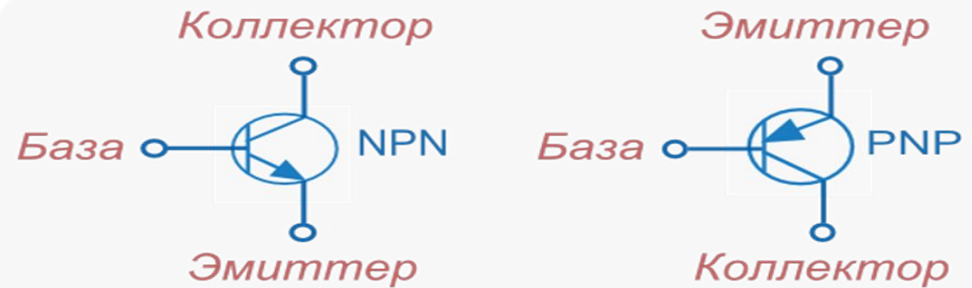
Обозначение на схеме биполярного транзистора
