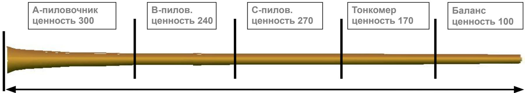
Измерительное устройство рассчитывает для каждого ствола наиболее оптимальный вариант раскроя, опираясь на заданные прайс-листы. Таким образом более дорогостоящая часть ствола используется более точно.
