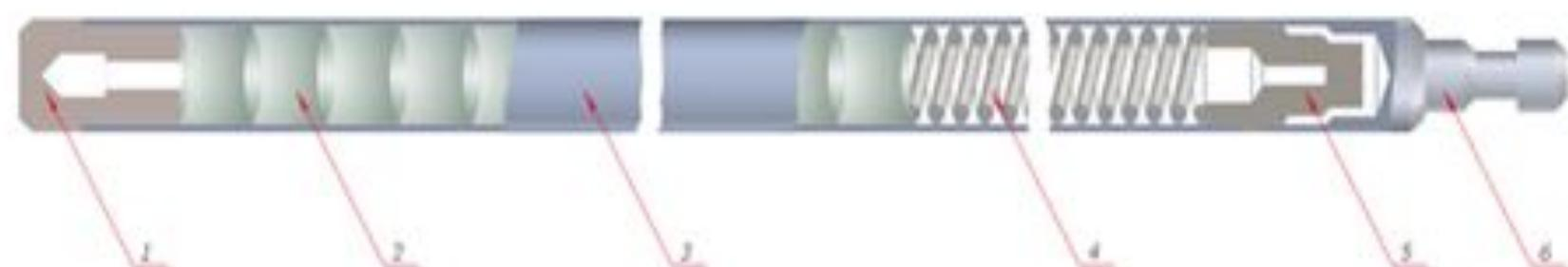
Рис.3.5. Устройство ТВЭЛА реактора РБМК: 1 — заглушка; 2 — таблетки диоксида урана; 3 — оболочка из циркония; 4 — пружина; 5 — втулка; 6 — наконечник. ¶
