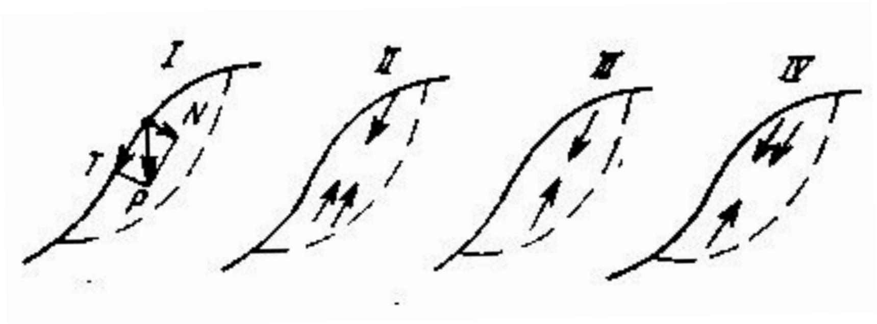
Схема расположения сил, действующих на склоне.
