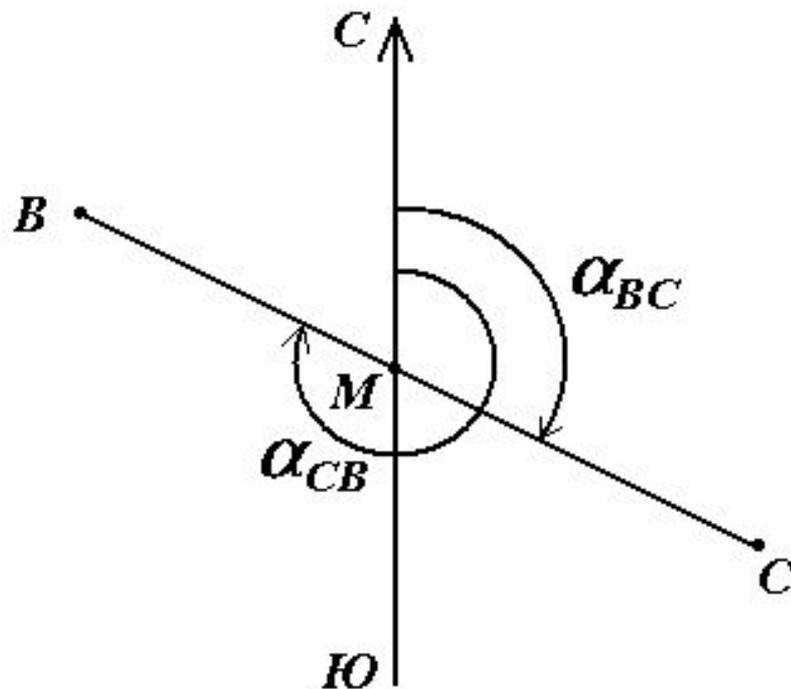
Иногда для ориентирования линии местности пользуются не дирекционными углами, а румбами (рис.). Осевым румбом называется острый горизонтальный угол, отсчитываемый от ближайшего направления осевого меридиана (северного или южного) до данной линии. Румбы обозначают буквой  $r$  с индексом, указывающим четверть, в которой находится румб.
