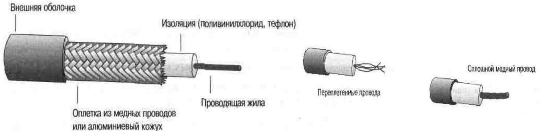
**Коаксиальный кабель** состоит из медной жилы (core), окружающей ее изоляции, экрана в виде металлической оплетки и внешней защитной оболочки. Жила, по которой передаются сообщения в виде кодированных электрических сигналов, окружена изоляционным слоем,
