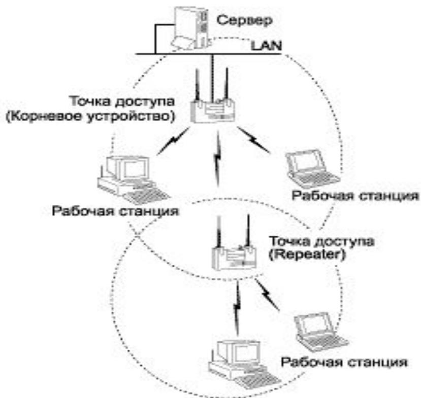
Схема объединения нескольких сегментов в единую компьютерную сеть
