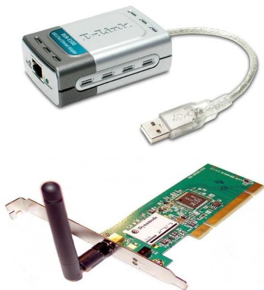
Каждый СА имеет свой уникальный сетевой адрес (LAN- или MAC- (физический) адрес), который указывается в служебной части пересылаемого пакета данных для идентификации отправителя и получателя. Он находится в специальной ячейке памяти СА. Производители получают адреса от Комитета стандартов локальных и глобальных сетей (известный под названием Project 802), созданный при институте IEEE.
