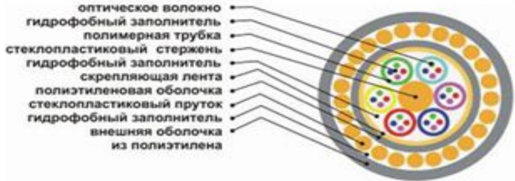
Оптоволоконный кабель передает сигналы по нескольким оптическим волокнам в виде модулированных световых импульсов и является надежным и высокозащищенным способом, поскольку передаваемые сообщения трудно перехватить, по сравнению с любым другим видом кабеля, проводящим электрические сигналы.
