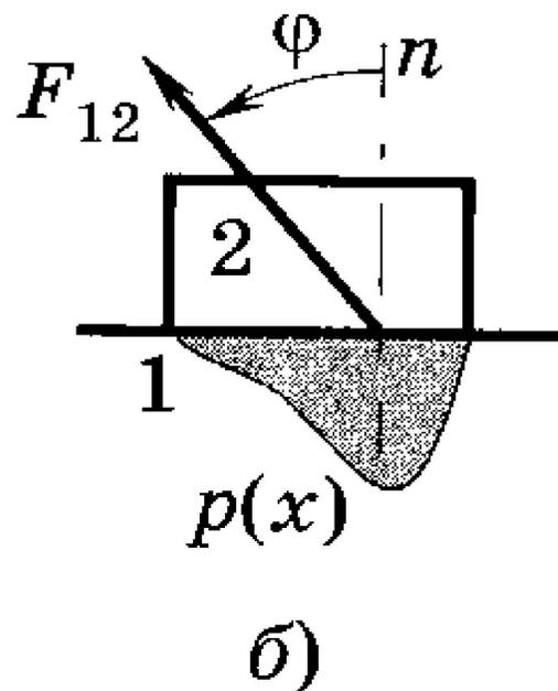
В плоской поступательной кинематической паре усилие взаимодействия звеньев распределяется по длине элементов с удельным давлением  $p(x)$ . Реакция  $F_{12}$  будет направлена либо по нормали к направляющей кинематической пары – если потери на трение малы, либо под углом трения  $\varphi$  к ней – если силы трения должны учитываться.
