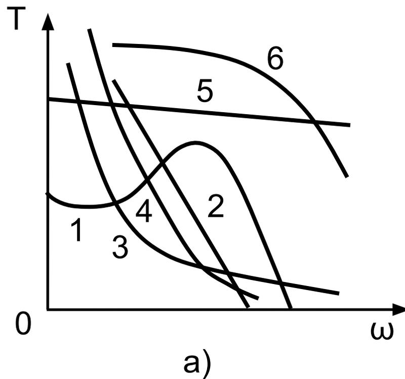
Рисунок 5.1а – Типовые механические характеристики различных двигателей
