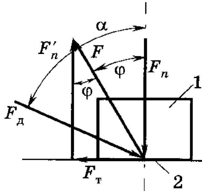
Рисунок 5.3 иллюстрирует следующую связь коэффициента трения с действующими силами:
